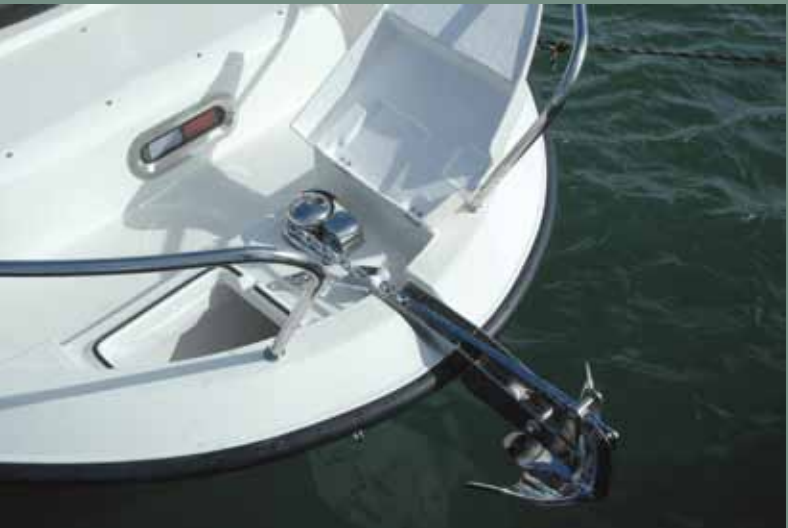
Verhältnismässig viel Platz in der Plicht; Backbords gibt es ein rutschhemmend strukturiertes Gangbord, dessen nutzbare Breite 24 Zentimeter beträgt - Die Ankerinstallation am Bug ist so auch bei widriger Witterung und schaukelndem Schiff gut erreichbar.
